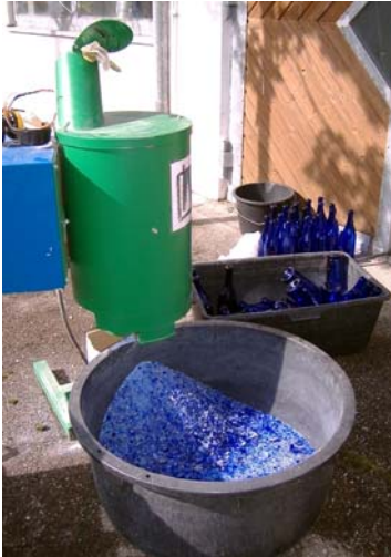
Abb.6: Der verwendete Flaschenbrecher
